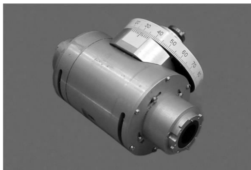
Рисунок 5.14 – Зовнішній вигляд фазообертача.
