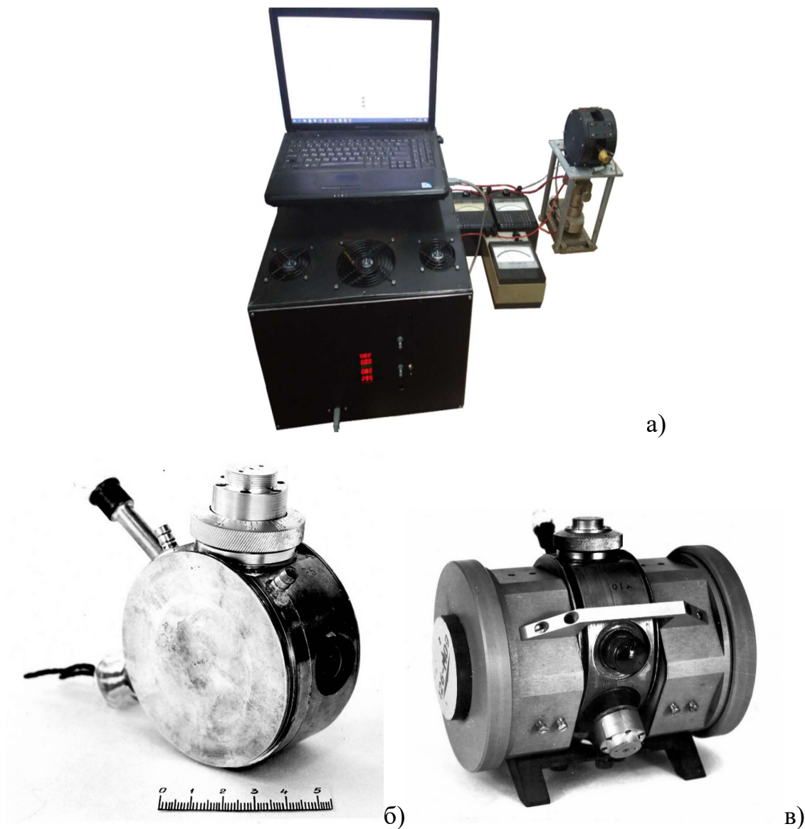
Рисунок 1.1 - Фото суб-ТГц ЕВП, що розроблено та виготовлено в ІРЕ НАНУ. а) пакетований в МФС 400 ГГц клинотрон з блоком живлення та керування з ноутбуку [99]; б) суб-ТГц ГДВ [104]; в) пакетований в МФС суб-ТГц ГДВ [104]
