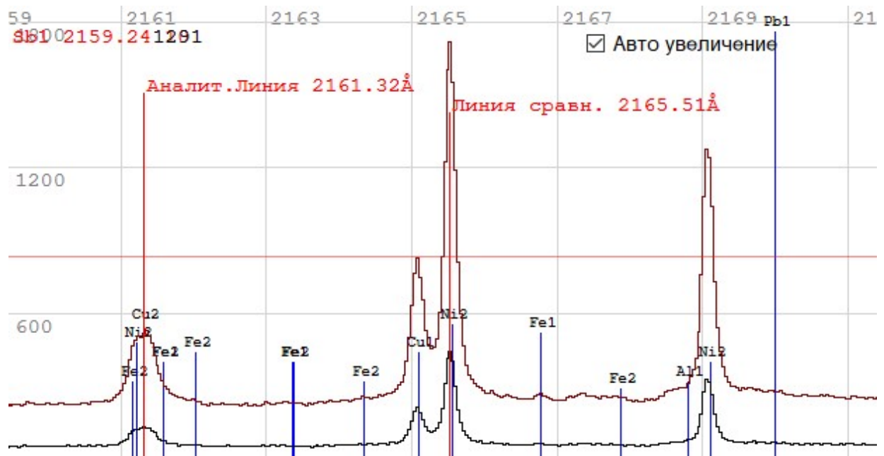
Рисунок 4.5 - Знімок з екрану реєструючого ПЗ. Фрагмент спектру стандартного зразку M1291, обраного для випробувань та вибудові калібровочного графіку міді.
