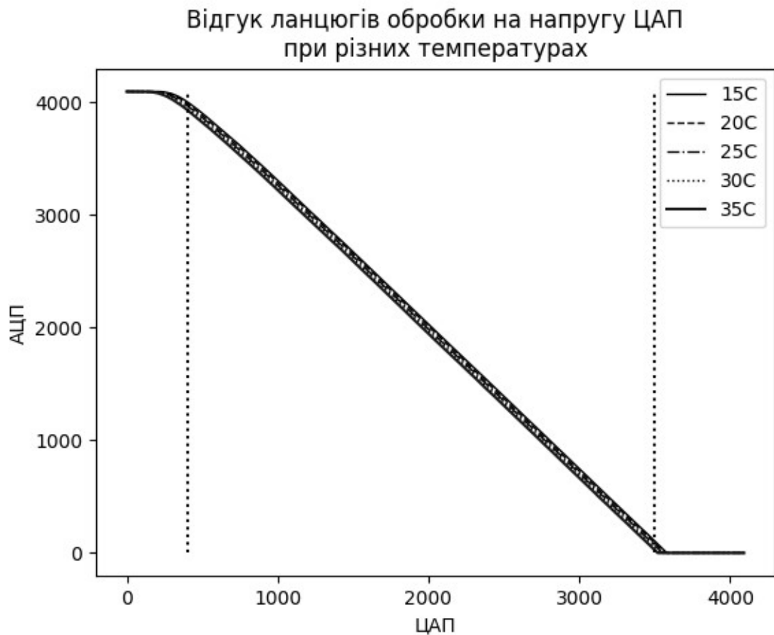
Рисунок 2.16 - Передавальна функція ланцюгів обробки. Пунктиром позначений діапазон, який використовується для обчислення середнього значення та коефіцієнта кореляції Пірсона ( r ).
