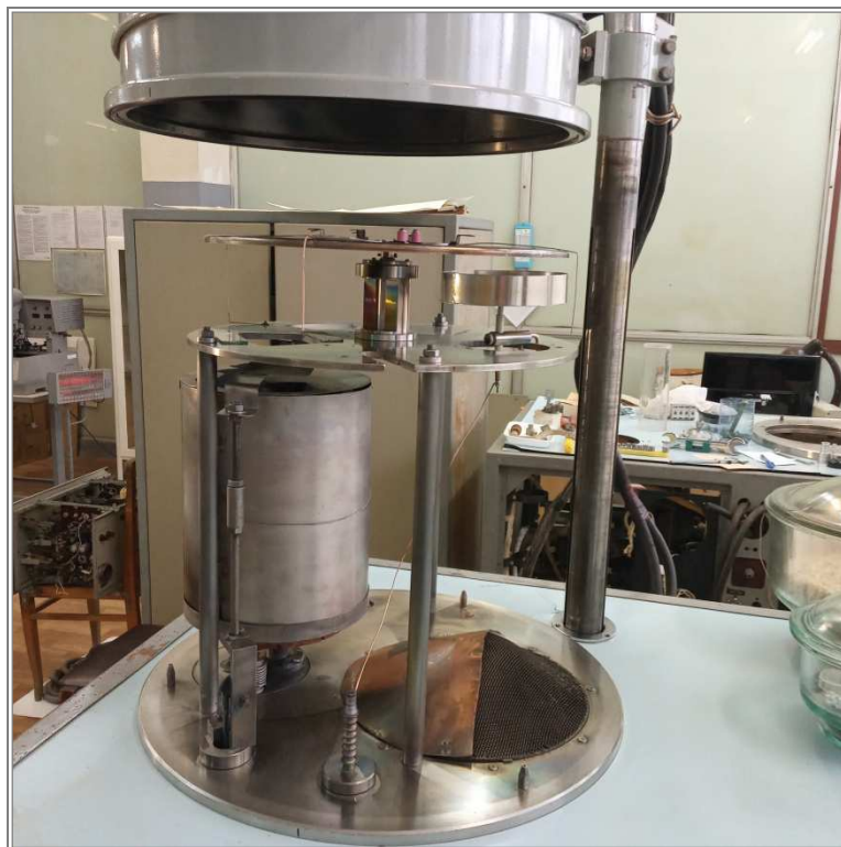
Підковпачне обладнання установки УВН-2М-2
