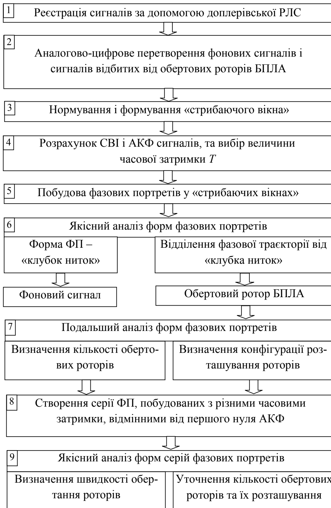
Рисунок 3.11 – Структурна схема методу аналізу сигналів, відбитих від мультироторного БПЛА, з використанням фазових портретів
