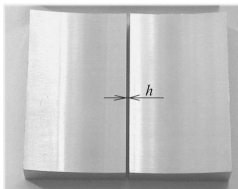
Рисунок 3.16 - Фокусуєче дзеркало складене із двох циліндричних відбивачів, розділених плоско-паралельною щілиною з шириною h
