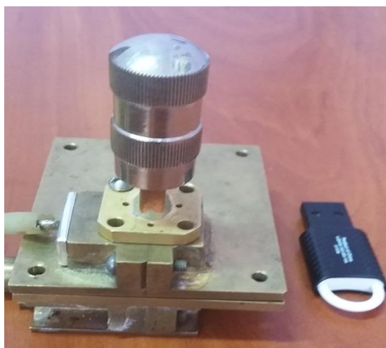
Рис. 4.7. Діючий експериментальний зразок суматора потужності на основі планарного ДР.
