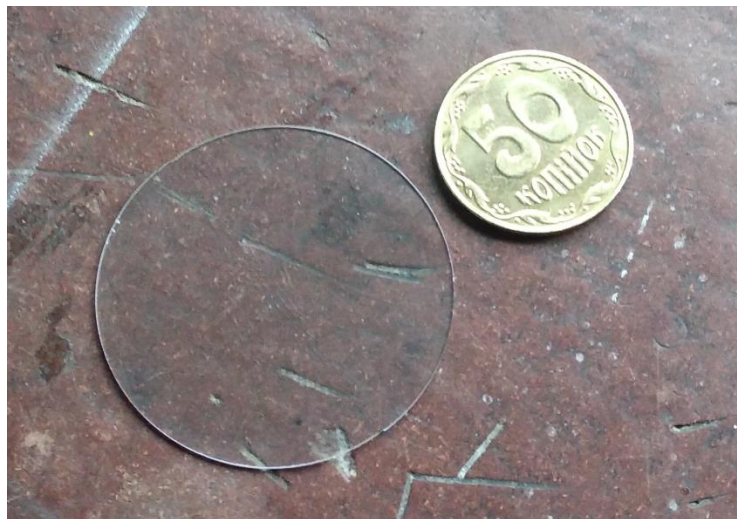
Рис. 3.1 Тонкий лейкосапфіровий диск, як основа планарного ДР.
