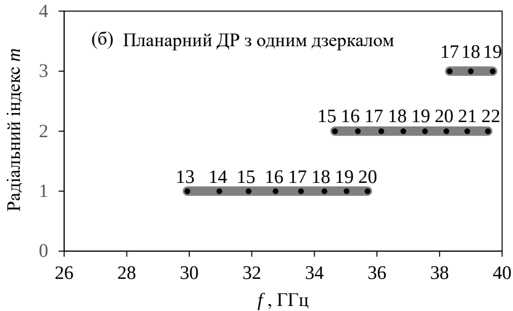
Рис. 3.19 Модові склади спектрів повністю (а) і аксіально частково екранованого (б) планарних ДР.
