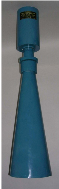
Акустичний перетворювач з плоскою акустичною хвилею АП-7Т
