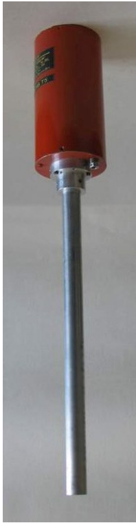
Акустичний перетворювач з плоскою акустичною хвилею АП-7Т
