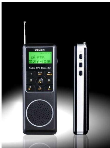
Рис. Д.4 Мультимедійний, всехвильовий, цифровий радіоприймач DEGEN DE-1127c MP3 плеєром та диктофоном.
