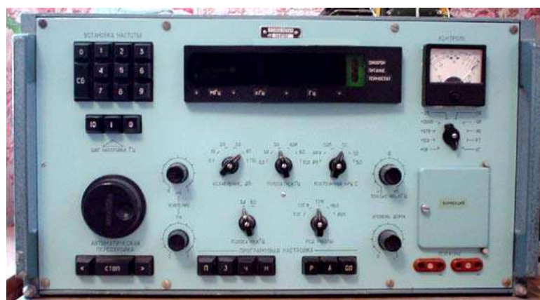
Рис. Д.3 Стационарный супергетеродинный коротковолновый радиоприемч Катран Р-399А
