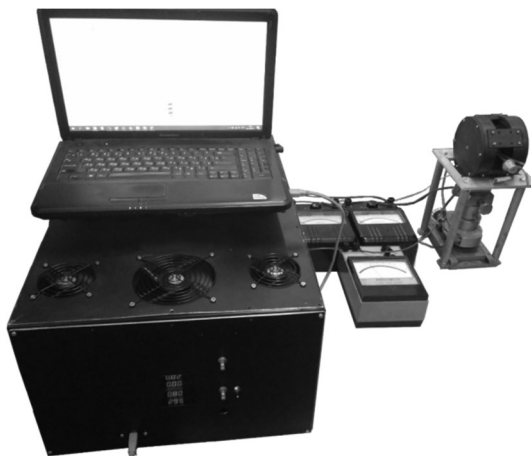
Рисунок 6.9 – Генераторний модуль на клинотроні 340ГГц зі схемою ПІД контролю напруги живлення ЕОС
