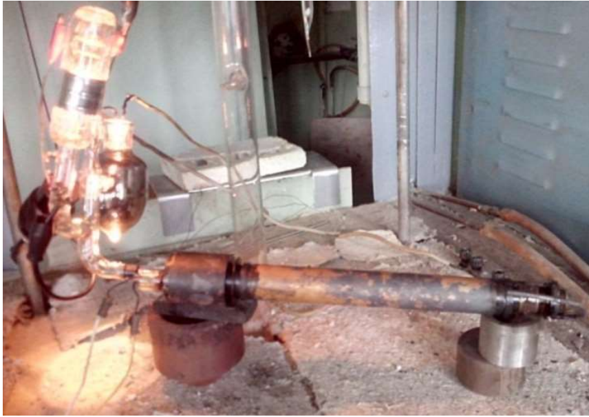
Рисунок 5.79 – Фотографія та схема конструкції експериментального макету: 1 - вузол планарної МІГ, 2 - канал транспортування ГЕП, 3 - колектор, 4 - ізолятор між колектором і каналом транспортування, 5 - оглядове вікно
