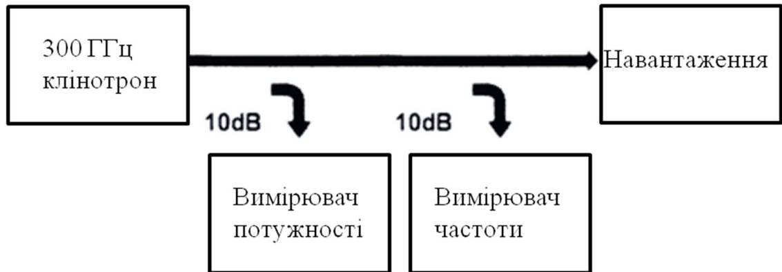
Рисунок 6.6 – Блок-схема вимірювання частоти та потужності випромінювання клінотрона
