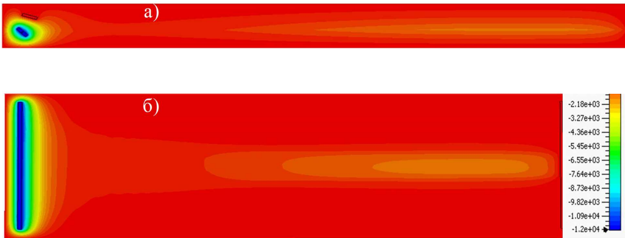
Рисунок 5.49 – Розподіл потенціалу електричного поля в стрічковому ГЕП вид збоку - (а) і зверху - (б)
