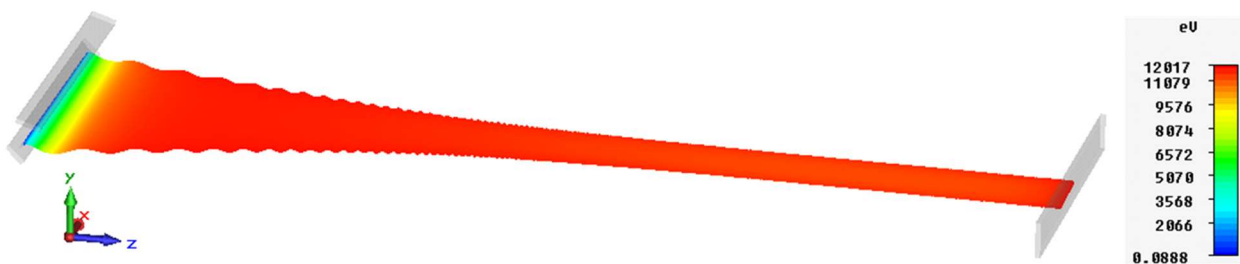
Рисунок 5.47 – Конфігурація стрічкового гвинтового електронного пучка
