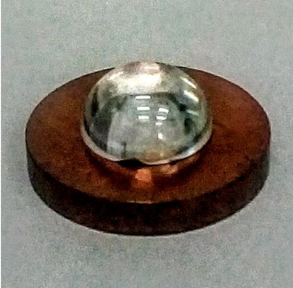
Рисунок 2.7 – Сапфіровий напівсферичний КДР з мідною ТПС
