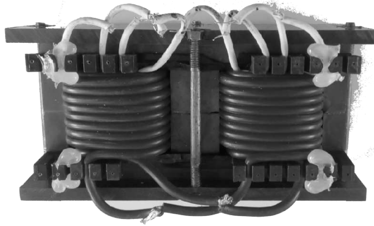
Рисунок 5.6 – Високовольтний трансформатор, що підвищує напругу для розробленого джерела живлення
