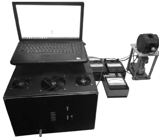
Рисунок 5.15 – ТГц комплекс з схемою ПД управління напругою та потужністю розжарювання
