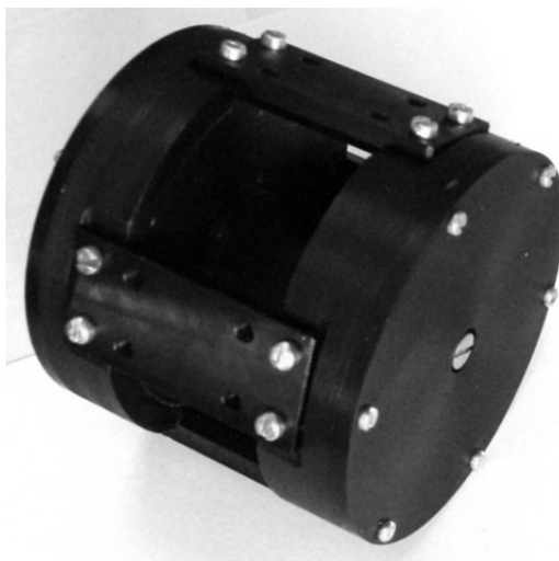
Рисунок 2.32 – Компактна магнітна система, що фокусує для клінофонів 2-мм діапазону [8]
