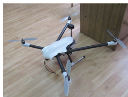
Рис. В.2. Зовнішній вид БПЛА: а – літакового типу Х-8, розмах крила 2,12 м, розрахункова кількість обертів двигуна 8000-11000 об./хв.; б – квадрокоптер, розрахункова кількість обертів двигуна 6000-10500 об./хв.
