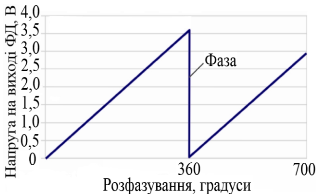
Рисунок 8 – Результуюча характеристика фазового детектора після застосування алгоритму корекції
