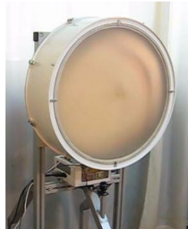
64-променева система формування зображень людини у 3-мм діапазоні хвиль з обертовою антенною дифракційного випромінювання
