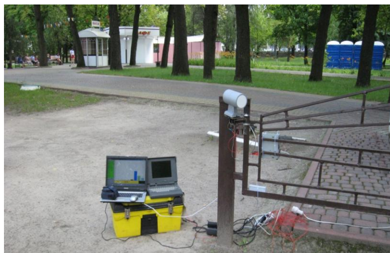
Рисунок 4.24 – Встановлений радіолокаційний датчик, персональний комп'ютер з індикацією на моніторі стовпчастої діаграми і реєстратор
