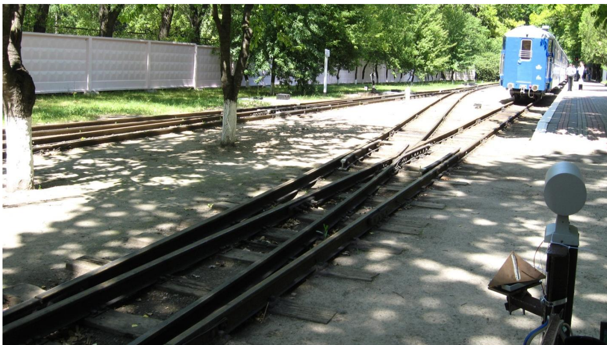
Рисунок 4.26 – Вимірювання параметрів радіолокаційного датчика в режимі «датчик швидкості»
