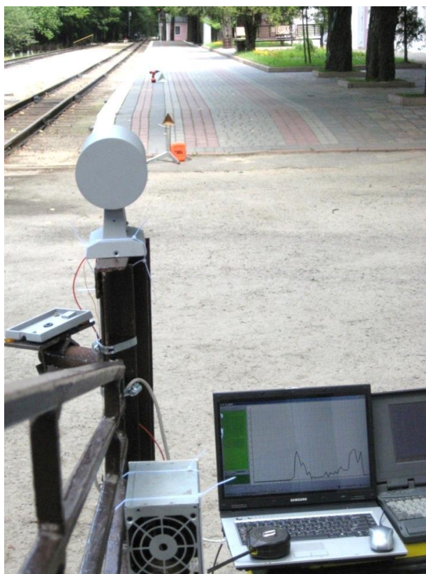
Рисунок 4.25 – Дослідження роздільної здатності по дальності радіолокаційного датчика
