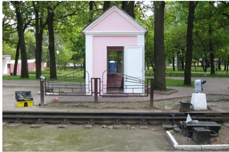
Рисунок 4.23 – Розташування радіолокаційного датчика, кутикового відбивача та апаратури, необхідної для настройки і перевірки працездатності заявлених параметрів, на залізничній стрілці
