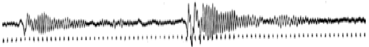
Рисунок 1.3 – Ранні записи твіків (осцилограма). Показані імпульси синхронізації з частотою 1000 Гц [53]
