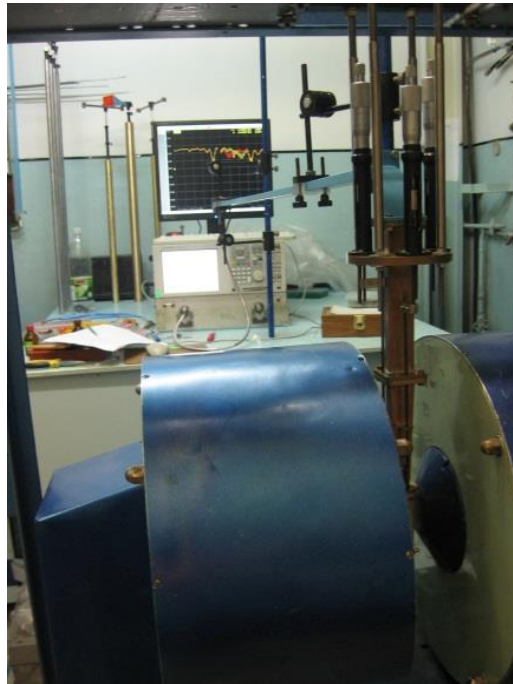
Рисунок 2.11 – VNA-ESR-спектрометр на базі векторного аналізатора кіл [31]
