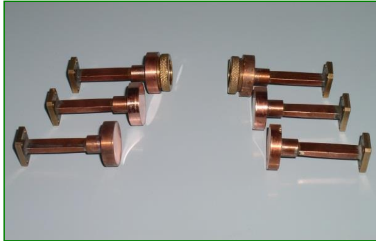
Рисунок 2.18 – Набір дзеркал різного радіуса кривизни для двохдзеркального відкритого резонатора
