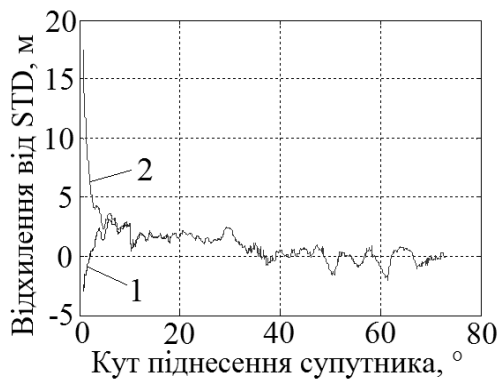
Рисунок 4 – Відхилення експериментальних даних від розрахованих ФВ: 1 – запропонована ФВ; 2 – ФВ Black&Eisner
