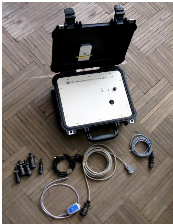
Рисунок 2.2 – Блок электроники Lemi-419 ANT
