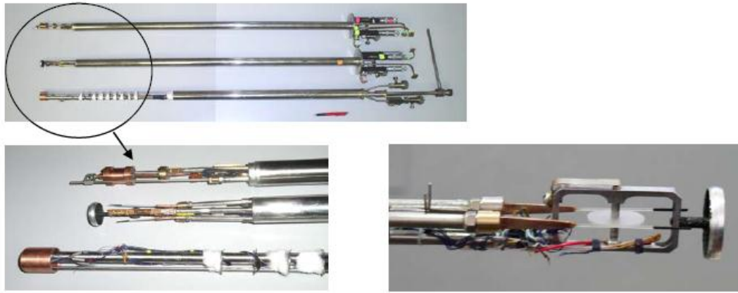
Модулі радіоспектрометра: вимірювальні та калібрувальні
