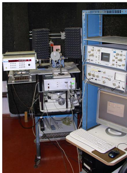
На основе ДДР разработаны резонансные ячейки для криогенного радиоспектрометра “ТОРНАДО”, сверхнизкотемпературного радиоспектрометра квантовых жидкостей и кюветы для измерения параметров жидких диэлектриков.
