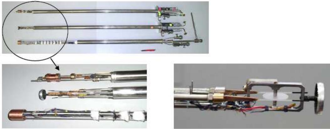
Модули радиоспектрометра: измерительные и калибровочные
