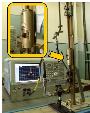
Ячейка Электронного Спинового Резонанса на основе планарного фотонного кристалла [5] - для исследования квази-двумерных магнетиков
